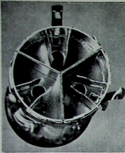
Afb. 15. Blik in de convergentiering van het elektronenkanon (voor een beter inzicht is de geterring verwijderd).
